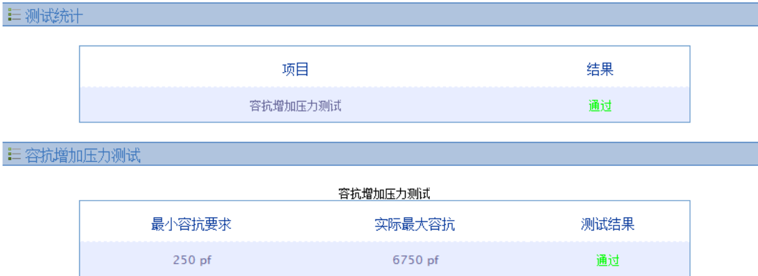
图 2.66 容抗增加压力测试报告范例
