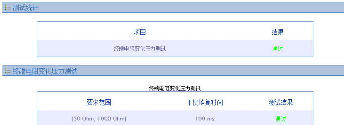
图 2.72 终端电阻变化压力测试报告范例
