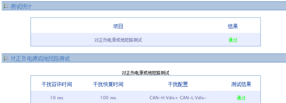
图 2.69 对正负电源或者地短路测试
