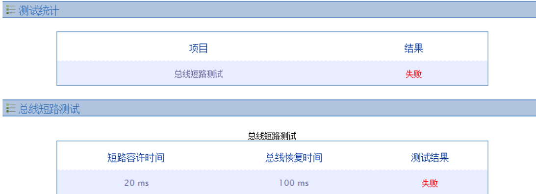
图 2.60 总线短路测试报告范例
