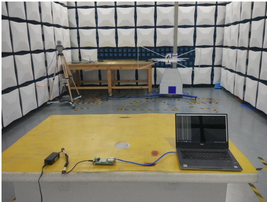
图 9 辐射骚扰试验配置 (CQC 广州实验室)
