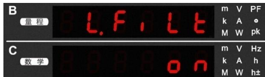
图 6.7 线路滤波器的开启/关闭
