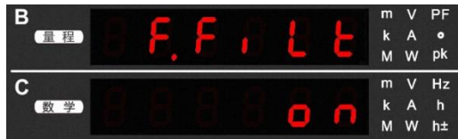
图 6.5 频率滤波器的开启/关闭
