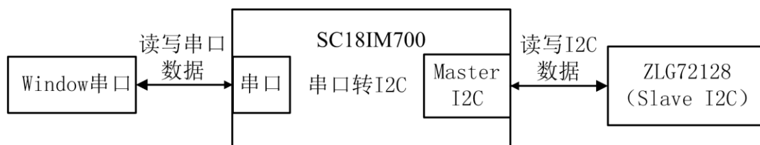
图 7.1 SC18IM700 通信流程图
