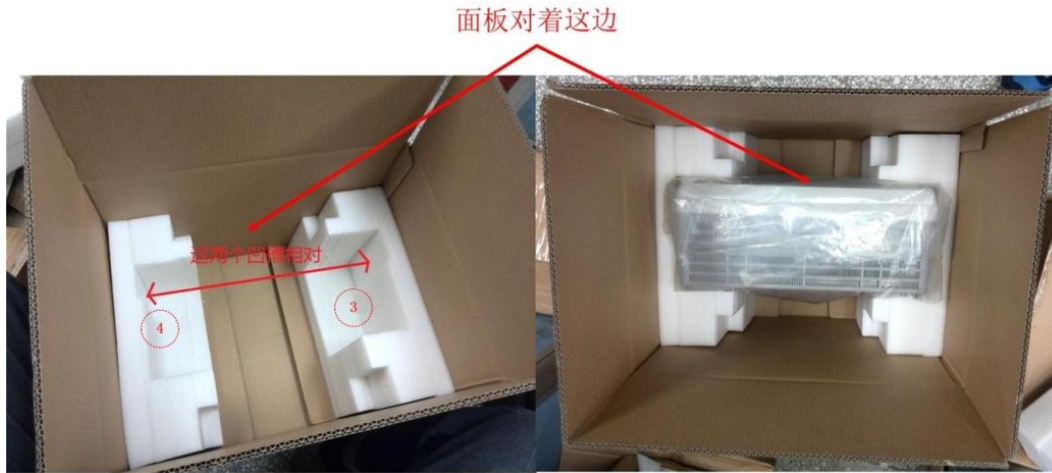
图 3.5 放置 PA 于包装箱中
