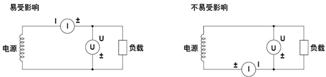
图 4.32 降低杂散电容对测量精度的影响
