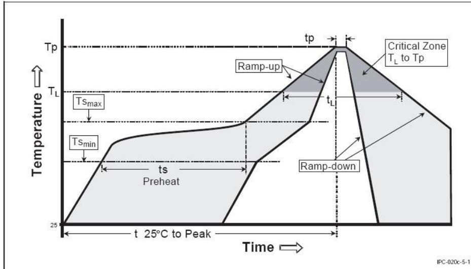
图 6-1 推荐生产回流温度曲线
