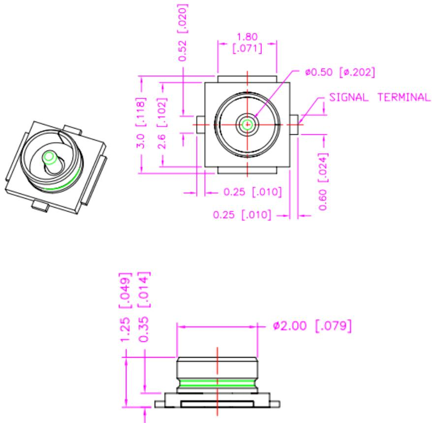
图 7-4 外接连接器参考尺寸图
