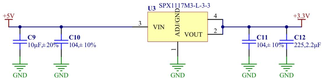
图 7-3 LDO 电源设计原理图
