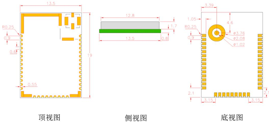
图 2-1 ZM32 系列 Zigbee 模块尺寸图（单位：mm）
