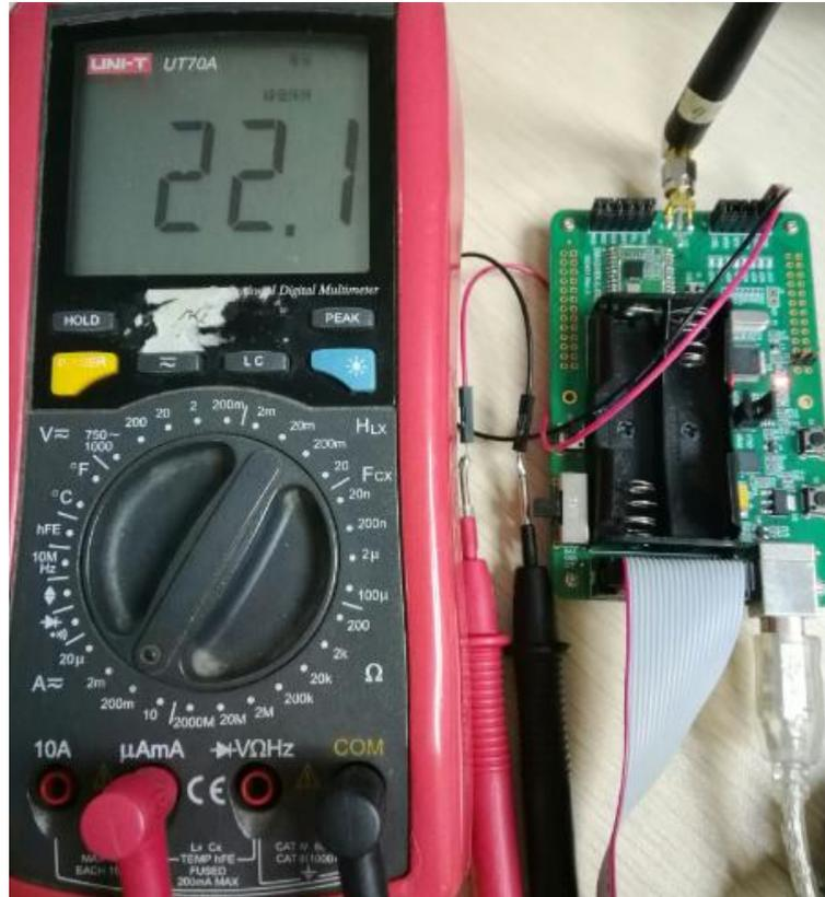
图 5 0dBm 功率发送测试
